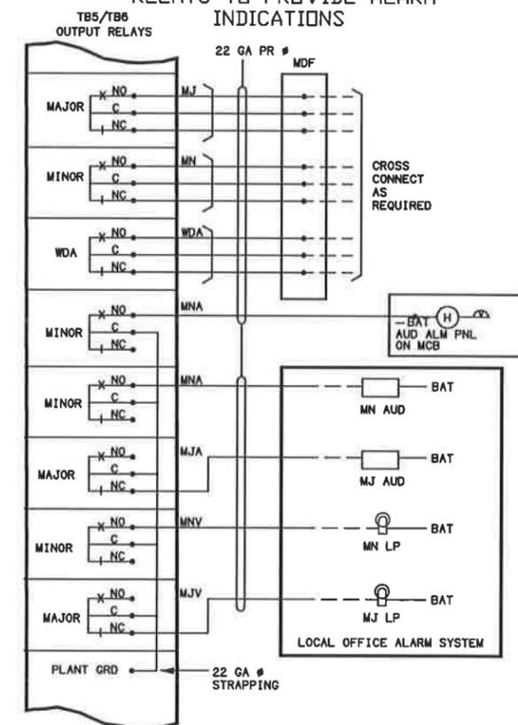
FIG 3 POWER PLANT LOAD MONITORING TYPICAL CONNECTIONS
