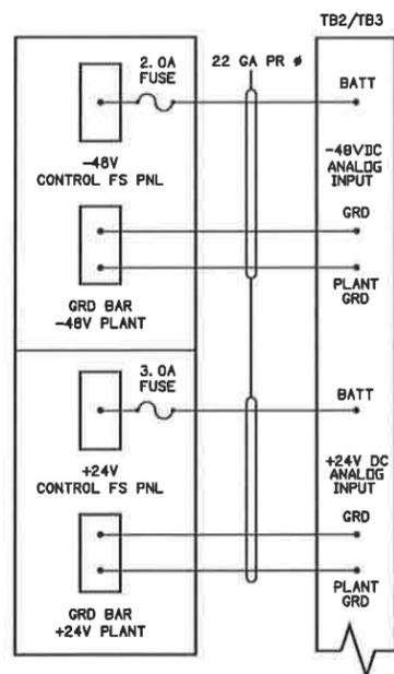
FIG 2 POWER PLANT VOLTAGE SENSING
